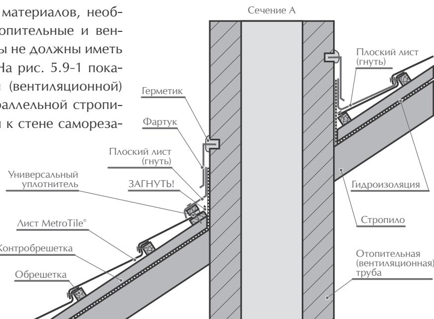
На рис. 5.9-2 показан разрез отопительной (вентиляционной) трубы в плоскости В, перпендикулярной стропилам.
